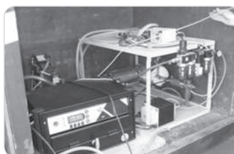
Figura 3.9. Equipo de medición de material particulado y sistema de dilución.
