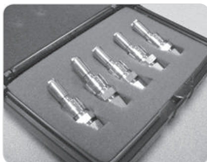
Figura 3.16. Orificios de calibración del equipo Apex 522.
