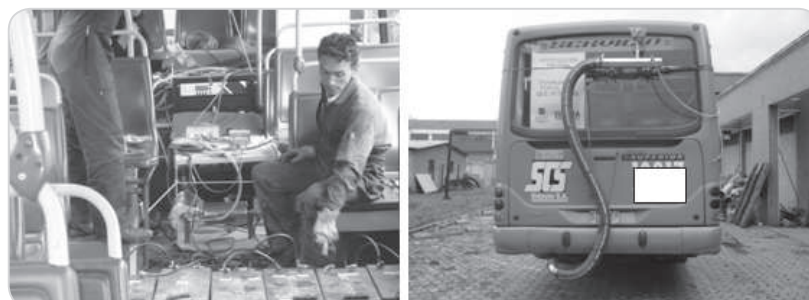
Figura 3.14. Montaje del sistema de medición en un vehículo de carga pesada.
