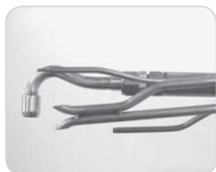
Figura 3.11. Tubo pitot y boquilla de la sonda de captura de muestra.
