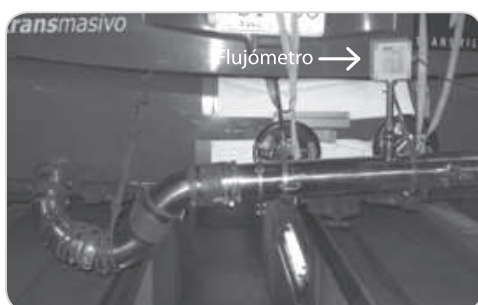
Figura 3.8. Tubo de muestreo y flujómetro.
