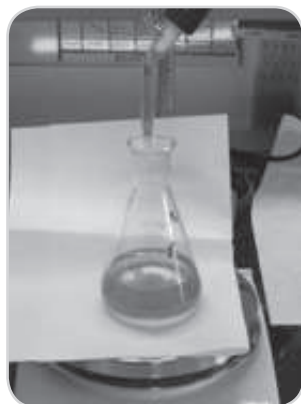
Figura 3.17. Titulación para determinación de dióxido de azufre.
