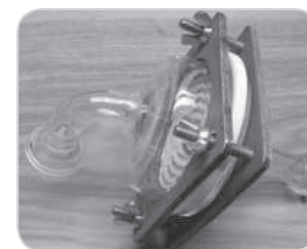
Figura 3.10. Portafiltras del equipo Apex 522.
