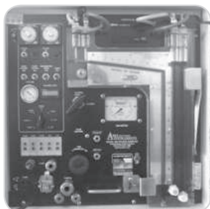
Figura 3.7. Consola principal del equipo muestreador isocinético Apex 522.
