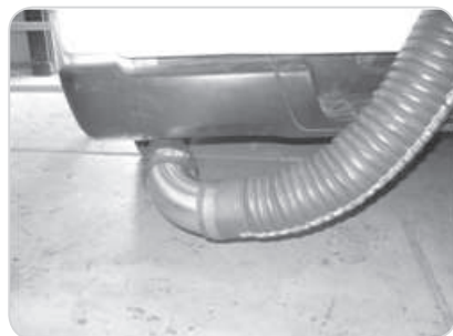
Figura 3.6. Manguera siliconada y acople al tubo de escape.
